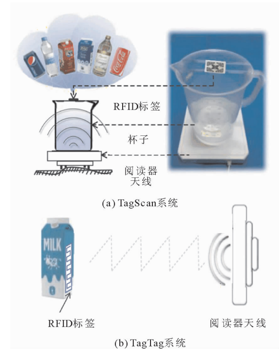
图 15 基于 RFID 的低代价液体识别系统 Fig. 15 RFID-based low-cost liquid identification system
